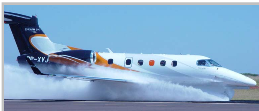
Ensaios do Phenom 300 – spray provocado pelo trem de pouso, durante o teste de não-ingestão de água.
