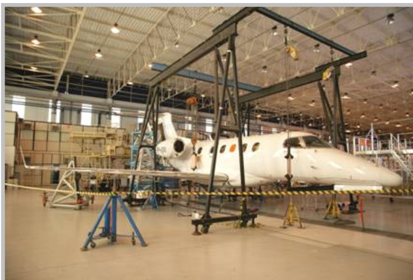
O jato Phenom 300 realizando o teste de vibração em solo
