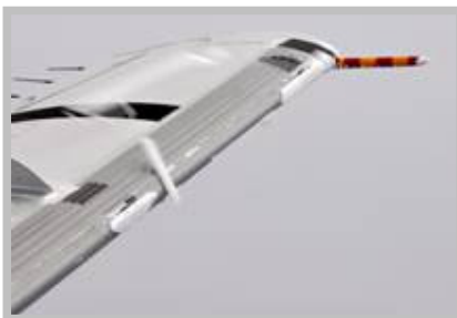
Teste de gelo natural: momento em que o boom da asa quebrou o gelo.
