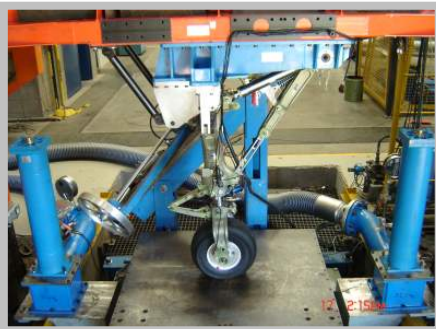
Ensaio de acionamento do trem de pouso dianteiro do Phenom 300
