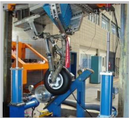
Ensaio de acionamento do trem de pouso central do Phenom 300
