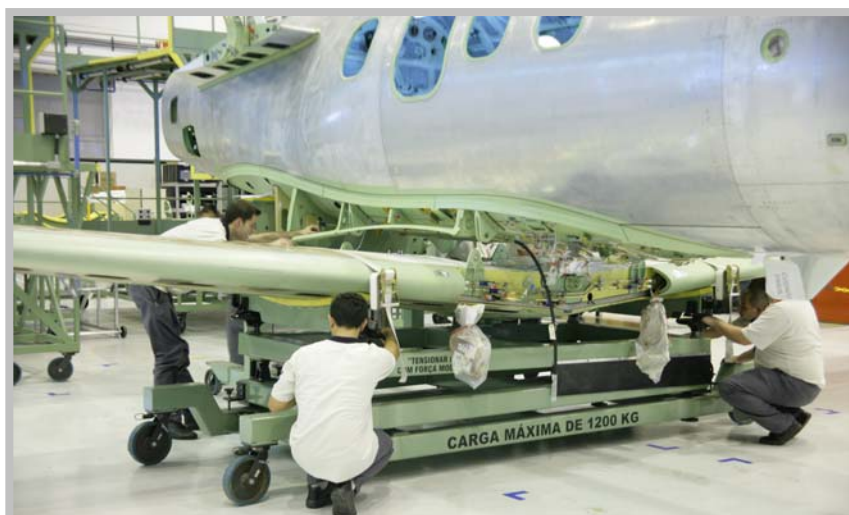
Junção asa-fuselagem do segundo Phenom 100
