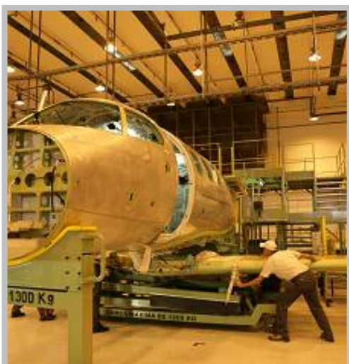
Encaixe da asa na fuselagem do segundo Phenom 100
