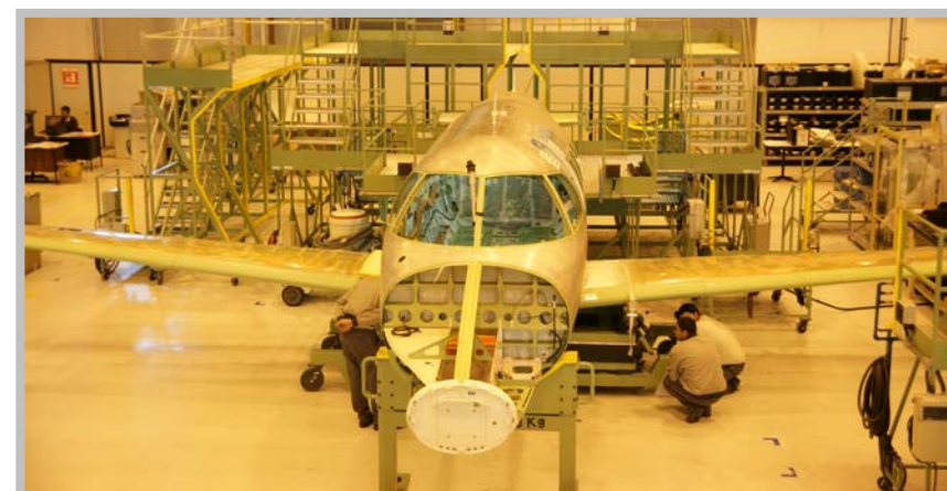
Junção asa-fuselagem do segundo Phenom 100
