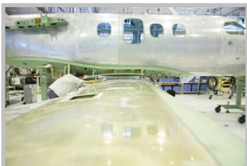
Posicionamento da asa do segundo Phenom 100
