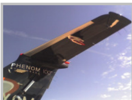
Phenom 100 equipado para os testes de flutter
